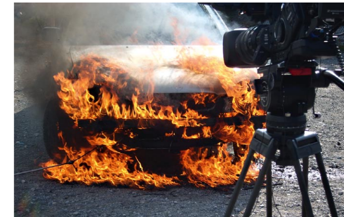
Brennendes Fahrzeug nach einer Leckage von 1234yf im Motorraum. Foto: em-punkt/DUH
